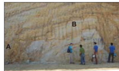
Fig. 1.36 → Deformazioni indotte dalla pressione di poro su soft sediment (com. pers. F. Storti) (A) e fragili (B) sulle sabbie del Pleistocene medio (Depositi fluviali antichi) nella zona di taglio della faglia antitetica del bordo sud della piana dell'Aquila ovest (località: sito del progetto C.A.S.E. di Pagliare di Sassa) (foto F. Balsamo e F. Storti).
