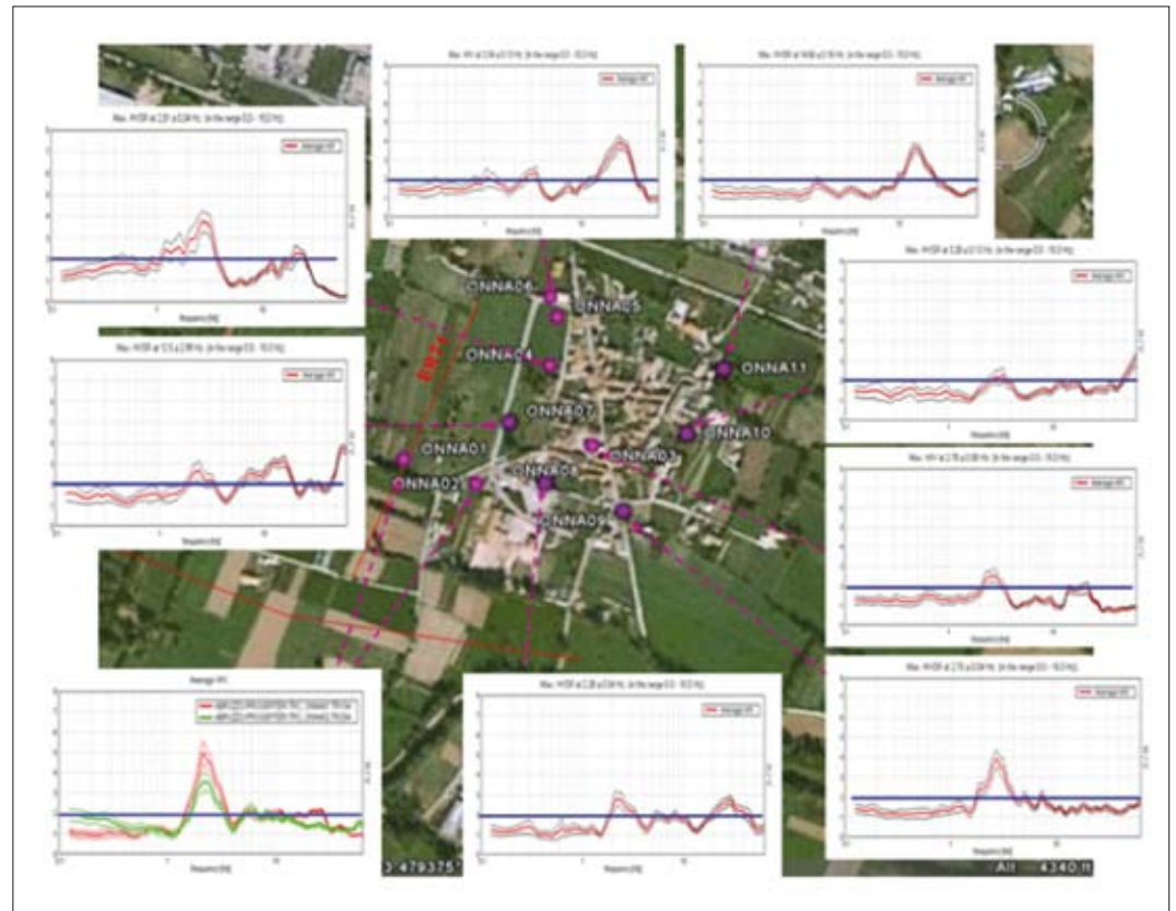
Fig. 5.4 → Mappa della distribuzione areale delle misure di microtremore e funzioni HVSR-frequenze di risonanza associate.
