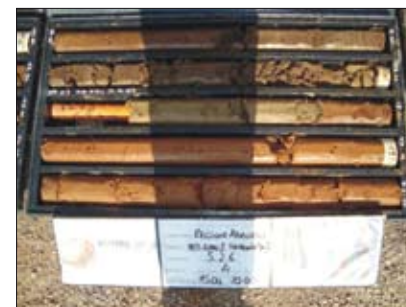
Fig. 1.14 → Limi argillosi bruni di Via Milonia (sondaggio S2.6, profondità 15-20 m).
