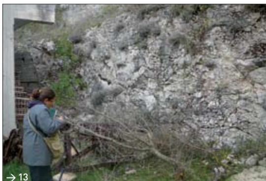
Foto 13 → Affioramento di calcari estremamente fratturati nei pressi del centro abitato. L'elevata fratturazione non consente l'individuazione di una stratificazione certa nell'ammasso roccioso.
