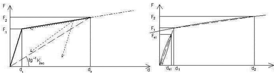
Fig. 11.9.1 - Diagrammi forza - spostamento per dispositivi non lineari
