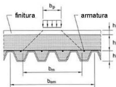
Fig. 4.3.12 - Diffusione del carico concentrato
