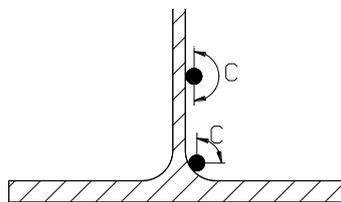
Fig. 4.3.10- Perimetro efficace delle barre di armatura.
