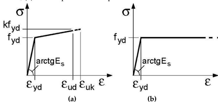
Fig. 4.1.3 – Modelli  $\sigma$ - $\epsilon$  per l'acciaio
